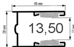
Stranggepreßtes Aluminium mit PVC-Einlage
